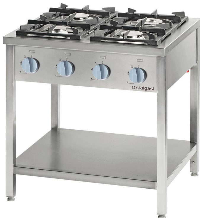
Kuchnia gazowa, 4 palnikowa, 700 mm, 20.5 kW, G20
